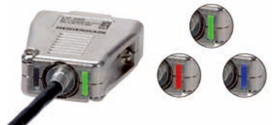
LIF, LIP 6071：接口电子电路的功能指示灯
